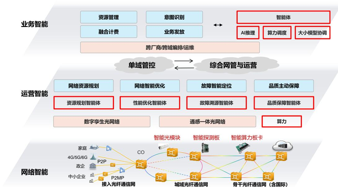
图 8 光网络智能化目标架构
