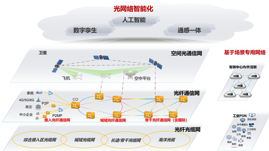
图 1 “全光网 3.0” 目标网络架构图
