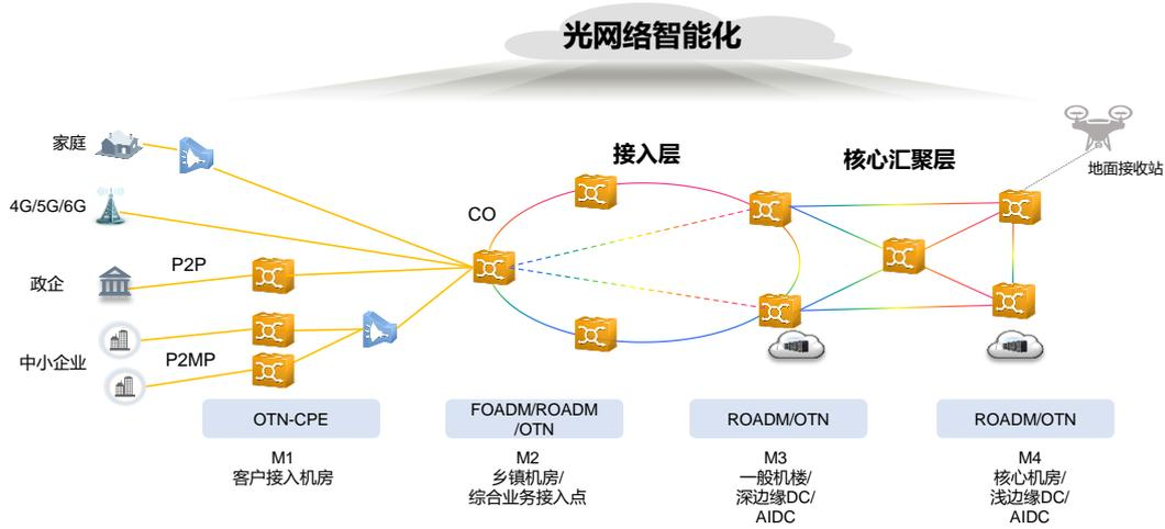
图3 城域光纤通信网目标架构
