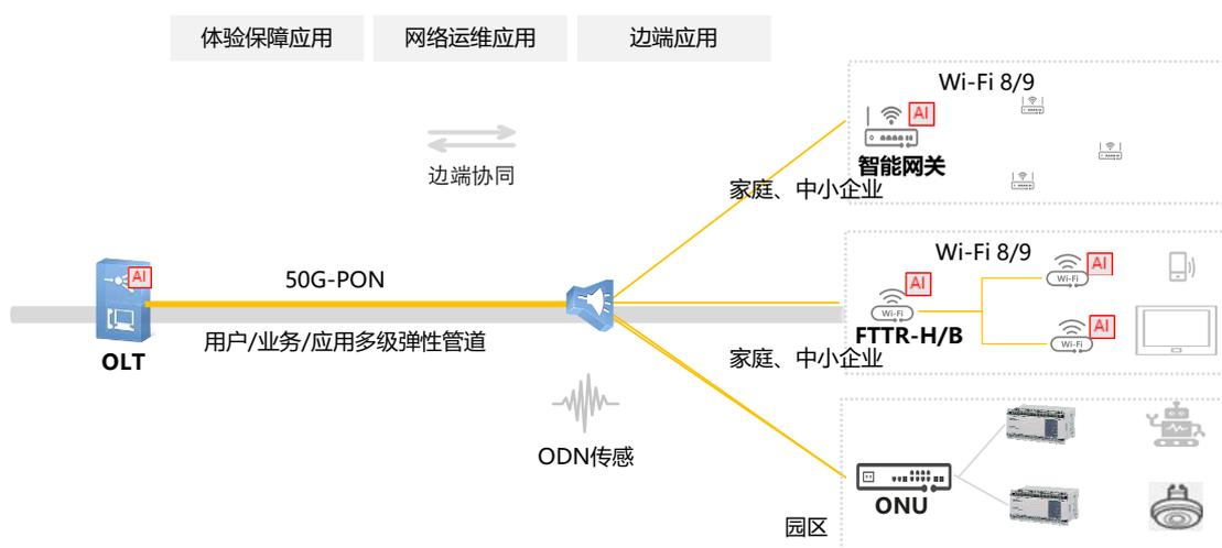
图4 接入光纤通信网目标架构
