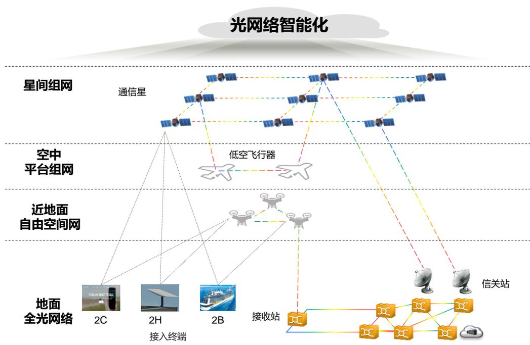
图 5 空间光通信网目标架构
