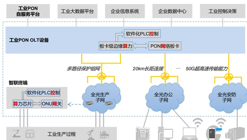
图 7 工业 PON 光网络目标架构
